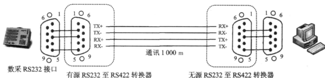
图 6 RS422 差分方式远程通讯
